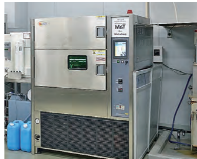
耐候性試験機(メタリングウェザーメーター) ：製品または素材の屋外暴露による劣化傾向を短期間で確認する。
