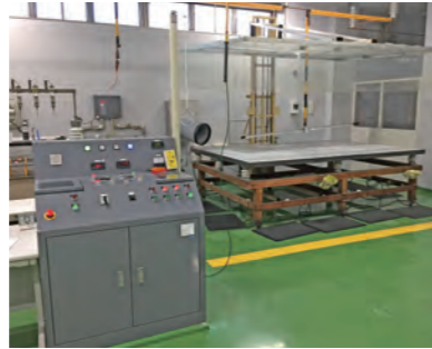
耐電圧試験機 ：電圧を印加し、製品または素材の絶縁性能を確認する。
