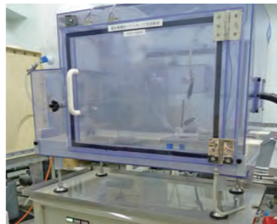
塩水噴霧耐トラッキング試験機 ：製品または素材に電圧の印加と塩水噴霧を行い、耐トラッキング性を確認する。
