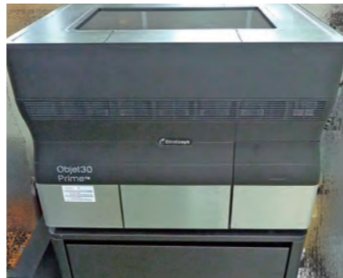
3Dプリンター ：3次元データを基に、試作品を立体的に造形する。
