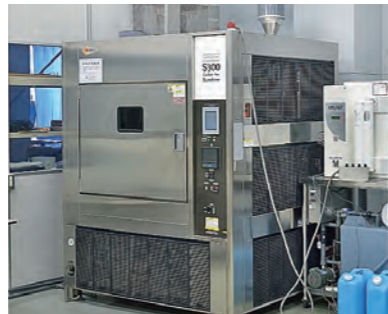
耐候性試験機(サンシャインウェザーメーター) ：製品または素材の屋外暴露による劣化傾向を短期間で確認する。
