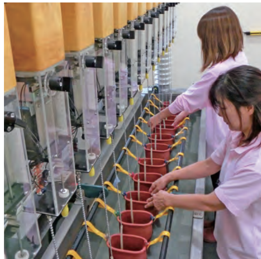
塩水噴霧耐トラッキング試験機 ：製品または素材に電圧の印加と塩水噴霧を行い、耐トラッキング性を確認する。
