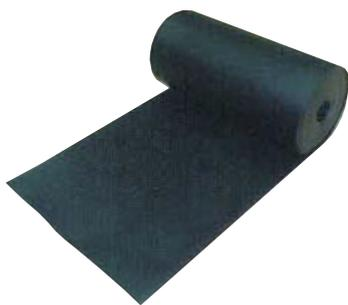
**使用目的** 地中埋設水道管の継手部或いは折損部からの漏水が周囲の土砂を巻き込んだサンドエロージョン現象を生じて、隣接するガス管を摩耗し、穴をあけることがあります。当該品は、この摩耗損傷の防止或いはガス漏れ発生までの時間を遅延させるためにガス管または水道管に巻き付けます。
