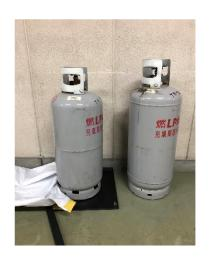
充填容器がシートを踏んでいないか確認してください。 ※充填容器でシートを踏むと破損の恐れがあります。
