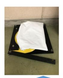
専用置き台手前のシート押さ え板3の蝶ナットを緩め、シー ト押さえ板3を取り外します。
