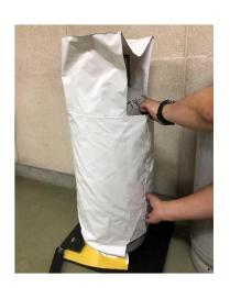
開口部側のマジックファス ナーを閉じ、シートを充填容 器に取り付けます。
